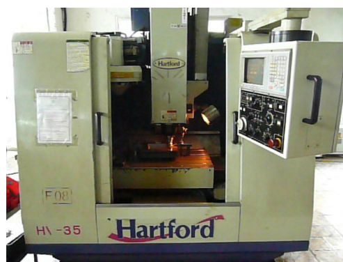
Trung tâm gia công khuôn CNC
